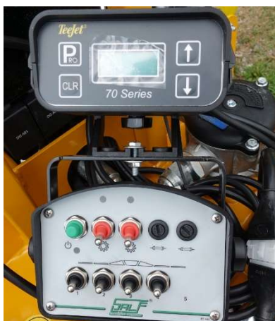
Abbildung 3: Drehzahlmesser und Steuerelement am Gerät Salf.
