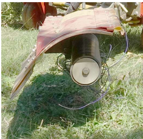
Abbildung 1: Gute Distanzen zwischen Prallschirm, Welle und Boden.
